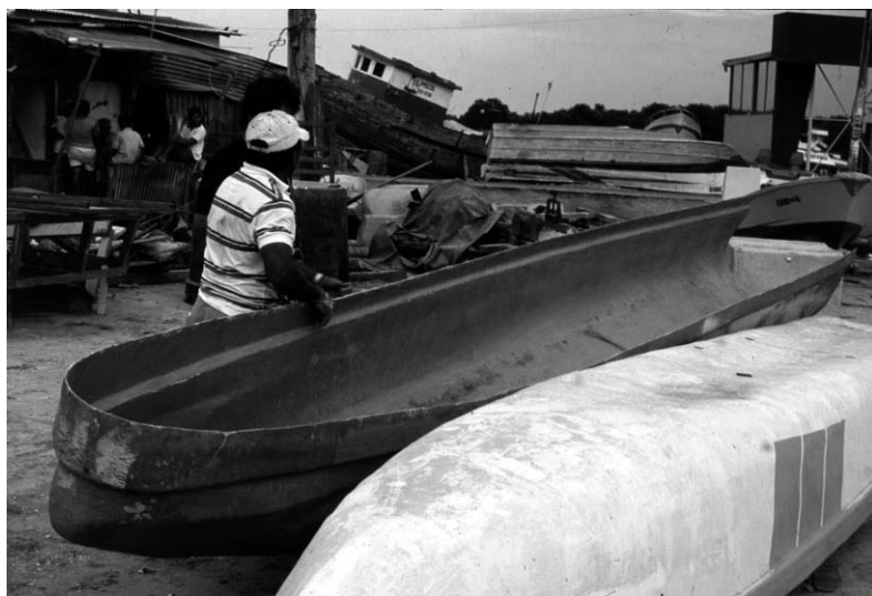
Foto 63. Molde y bote de fibra . Astillero de Puerto Bolívar.
