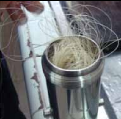
1. Se colocan los ovillos en los contenedores
