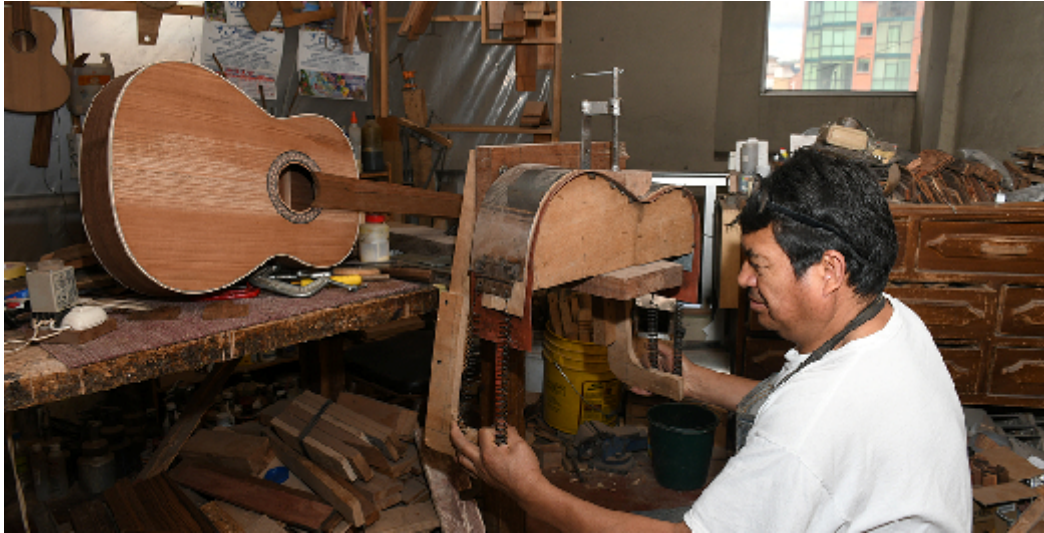
Jesús Ortega trabaja en la máquina dobladora de aros, que utiliza para dar cuerpo a las guitarras.
