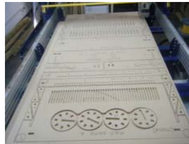
Figura 14 Estructura de MDF (cartón prensado) del telar de pedal en la mesa de corte CNC.
