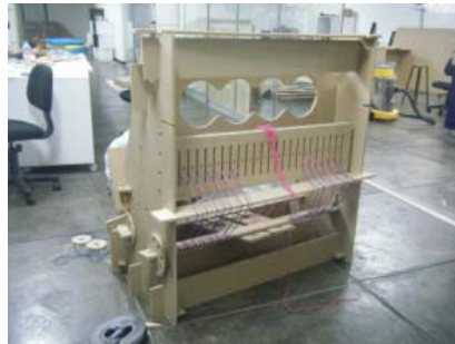
Figura 13 Vista posterior del telar de pedal, donde muestra los separadores de hilos que permiten tejer
