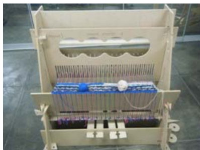
Figura 12 Vista frontal del telar de pedal, donde se muestra la zona de trabajo
