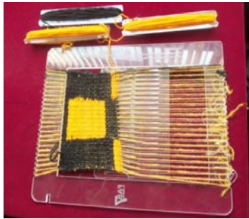
Figura 17 Prototipo de telar de bastidor, también llamado minitelar, que se emplea para iniciarse en el aprendizaje de técnicas de tejido tradicional.
