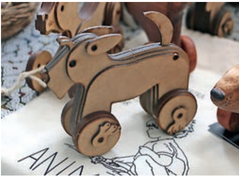
Figura 12. El corte láser permite crear piezas a medida, como este juguete (perrito) que está hecho de láminas de MDF seriadas (conjunto de planos bidimensionales que, colocados en el orden y distribución adecuada, representan o simulan un objeto tridimensional sólido). Este tipo de artesanías va cambiando la expresión de la cultura material.
