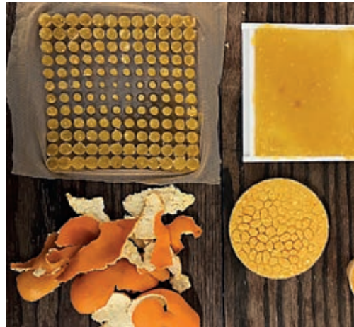
Figura 30. Bioplástico basado en cortezas de naranja. Montserrat Ciges, Materiom HUB, CIC Fab lab, Boston.
