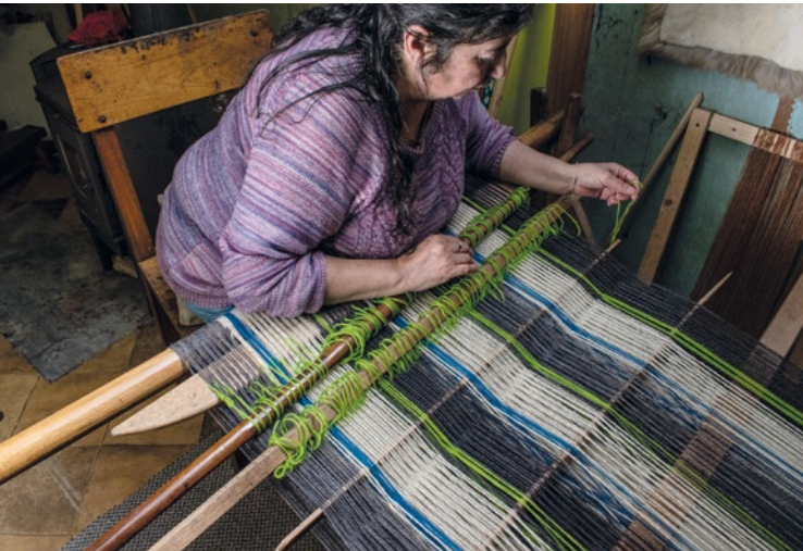
› Proceso de elaboración de tononwes en las tres cañas que conforman el tejido. Ejercicio textil realizado por Adriana Tureuna Tureuna. Comuna de Quemchi, archipiélago de Chiloé.
